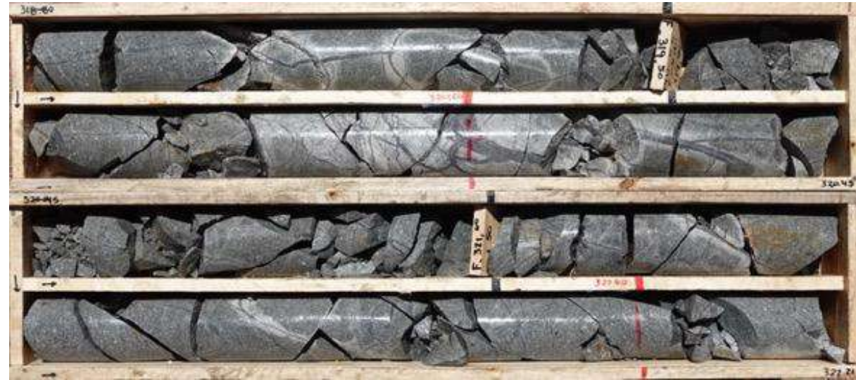
Hole PIU06: Chalcopyrite-chalcocite-pyrite sulfide assemblage
